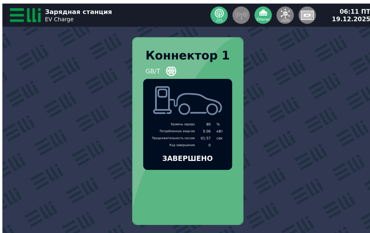
Рисунок 14. Вид основного экрана управления панели оператора с отображением информации о завершении зарядной сессии GB/T интерфейса
