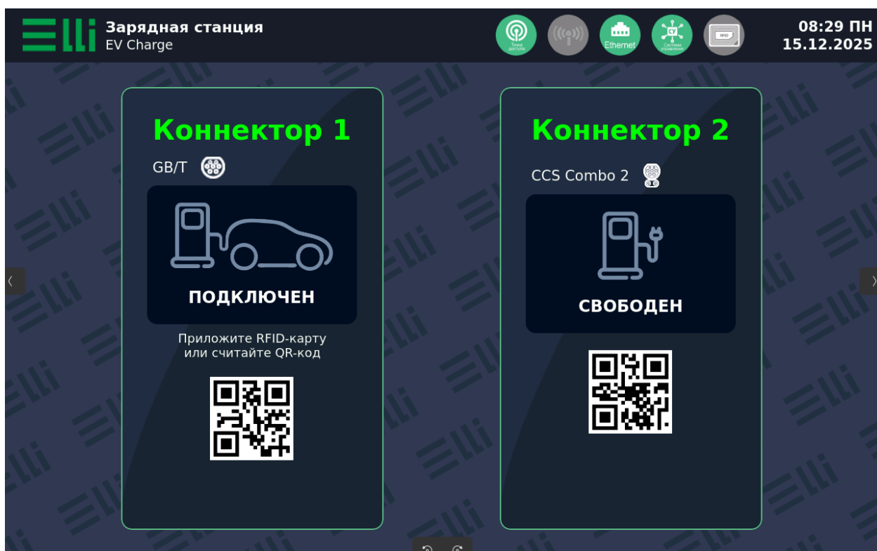
Рисунок 11. Вид основного экрана управления панели оператора с отображением информации о подключении GB/T коннектора
