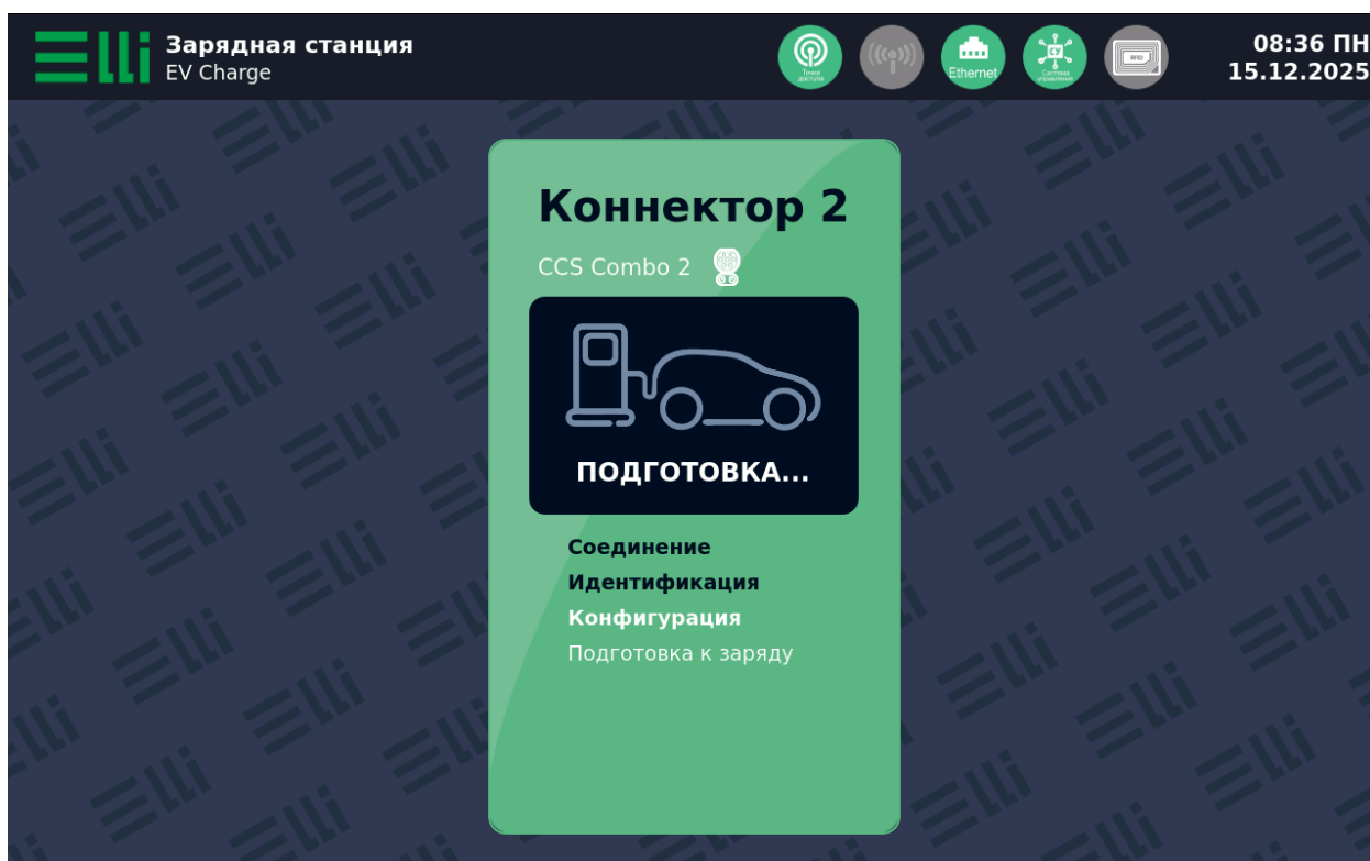
Рисунок 27. Вид основного экрана управления панели оператора с отображением информации об инициализации зарядной сессии CCS2 интерфейса
