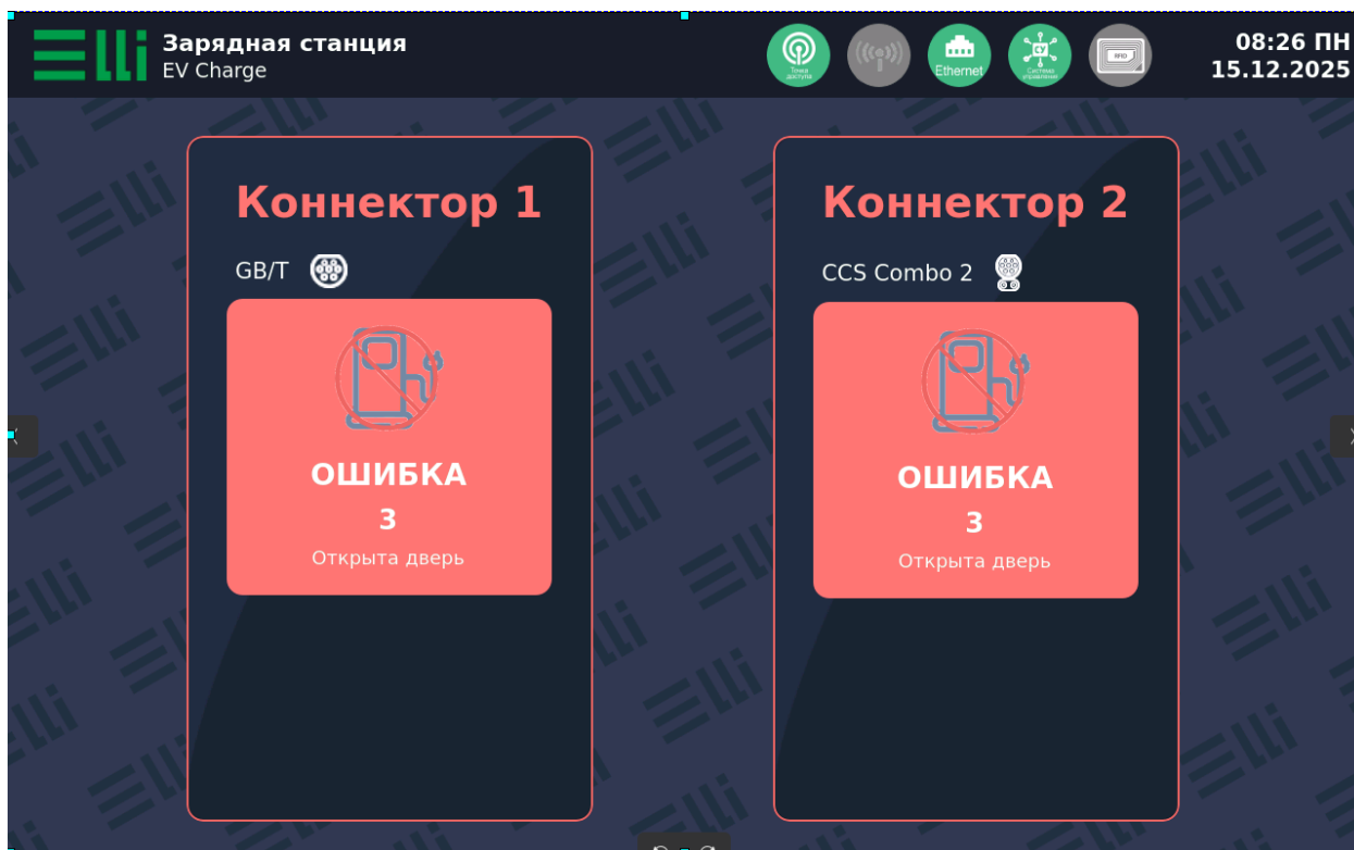
Рисунок 15. Вид основного экрана управления панели оператора с информацией об открытой двери
