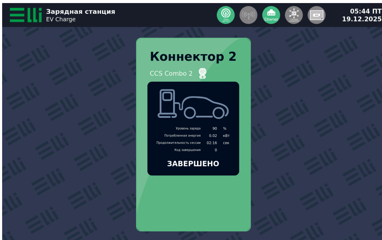
Рисунок 30. Вид основного экрана управления панели оператора с отображением информации о завершении зарядной сессии CCS2 интерфейса
