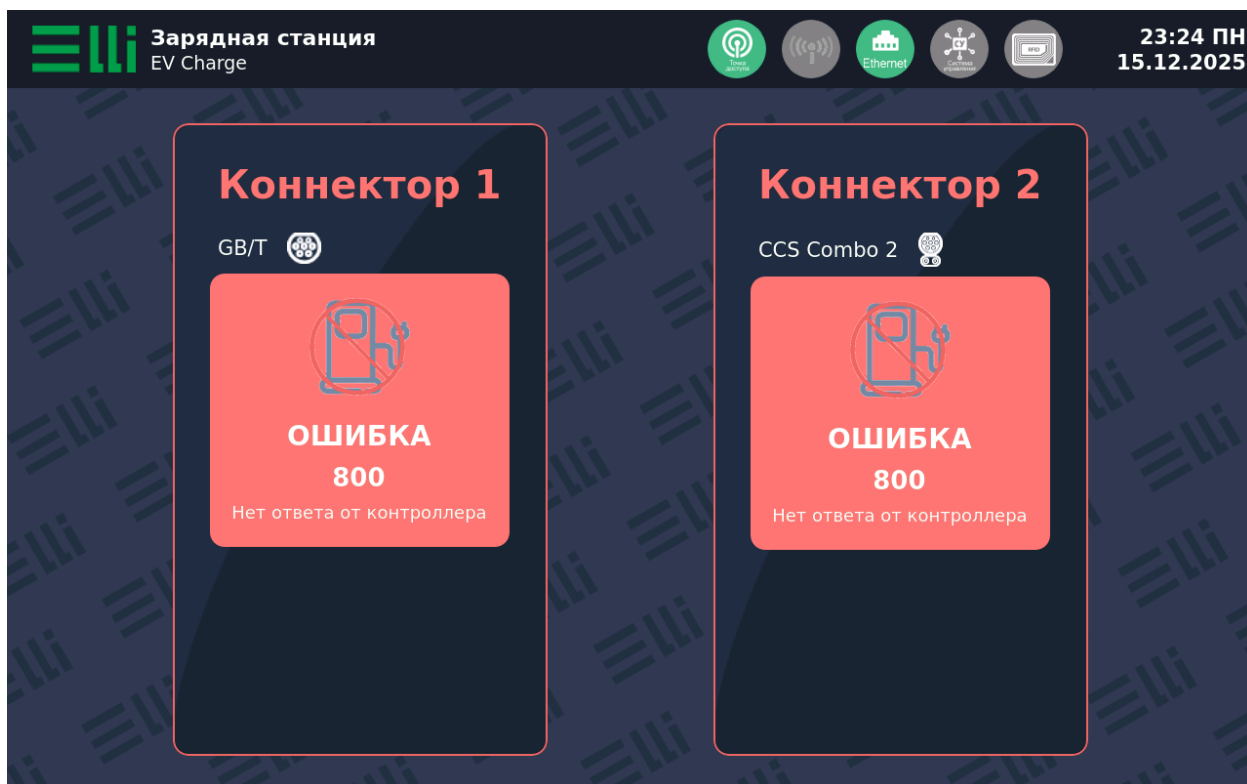
Рисунок 2. Вид основного экрана управления панели оператора с отображением об отсутствии связи с контроллером заряда
